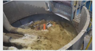
パルパー（古紙を水で混ぜて溶解する）
